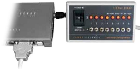
Les entrées 1 à 8 sont câblées sur 8 interrupteurs, Un commutateur binaire relié aux entrées 9 à 12, permet le choix de 15 programmes. Les 8 sorties sont câblées à des lampes LED deux couleurs.
