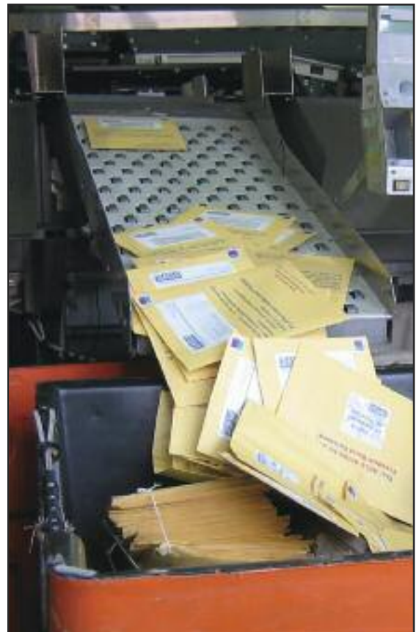
Application d'automatisation / tri
