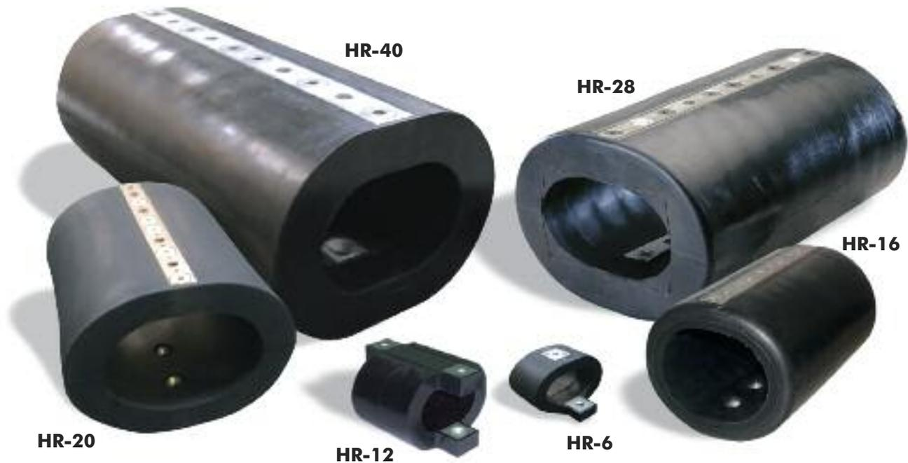
L'isolateur **HERM** comprend l'utilisation d'un isolateur à câble traditionnel à fil hélicoïdal Enidine enrobé d'un composé d'élastomère. Le câble en acier inoxydable du montage offre une construction robuste, tandis que l'élastomère fournit un complément d'amortissement et de rigidité. Cette conception unique offre une plus grande rigidité et capacité d'absorption d'énergie.
