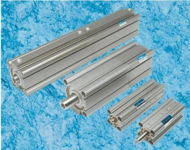
**DELTA EQUIPEMENT** vous propose le vérin EFP Extruded Flat Multiposition (profilé plat multi-position) de BIMBA. Ce vérin double effet, simple à tige, offre 3 positions dans un seul vérin. Ce vérin est une conception à 2 pistons qui économise de l'espace en utilisant le plan de pose EF existant et élimine la nécessité d'un vérin supplémentaire. Il peut aider à simplifier les changements de machine et, par conséquent, permet d'économiser les coûts.
