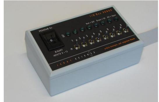
Pour mise en service et essai. 8 commutateurs sont câblés sur les sorties 1 à 8. Le sélecteur rotatif codifié en binaire est relié aux entrées 9 à 12. Ainsi, les programmes de 1 à 15 peuvent être présélectionnés (mode 10 ou supérieur). Par le biais de l'entrée 8 de déclenchement, le démarrage du programme présélectionné a lieu. Les sorties de la Xvi 75V8 peuvent être librement configurées en 0 V ou 24 V ou les deux. Les 8 LED indiquent les états.
