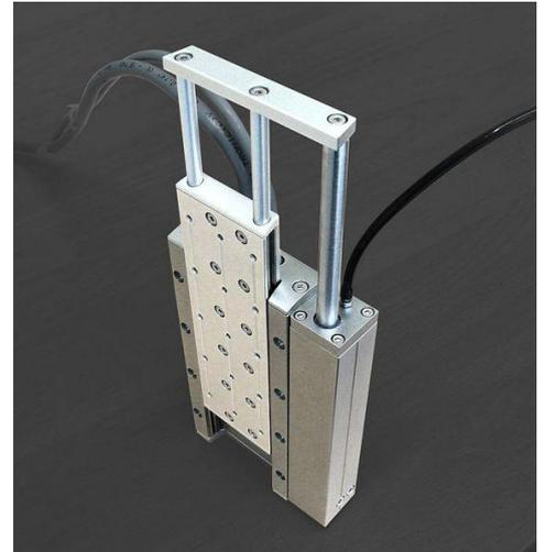
Un avantage important de la compensation du poids est la décharge du moteur linéaire vertical. Celui-ci travaille sans pesanteur et chauffe donc bien moins. Cette économie d'énergie peut être utilisée pour une dynamique plus élevée.
