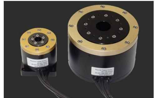
L'entraînement direct est un moteur de couple sans fer et sans réluctance. Un codeur de mesure haute résolution est intégré et présente une impulsion zéro par rotation en tant que référence. Les moteurs RT à arbre creux peuvent être commandés directement avec un servo-contrôleur XENAX® Xvi.
