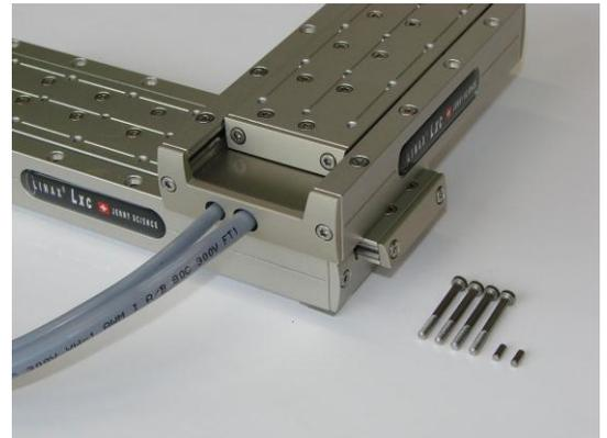
Les différents modèles d'axes linéaires LINAX® peuvent être vissés entre eux comme construction modulaire. Concernant les tables à mouvements croisés, divers écarts de trame sont possibles. Concernant le choix des vis et goupilles de centrage, l'axe à moteur linéaire « supérieur » est déterminant. Si, par exemple, un axe Lxc F10 est prévu en-haut et qu'un axe Lxc F40 est prévu en bas, il faut alors utiliser les visseries de l'axe Lxc F10 de la table croisée.
