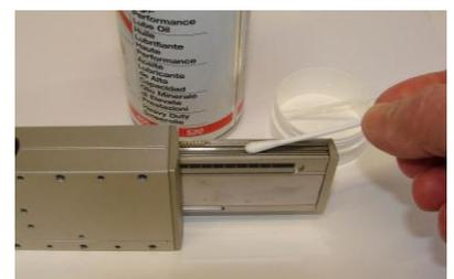
Pour ce faire, le plus simple est d'utiliser un coton-tige imbibé d'huile et de mouiller tous les points accessibles à l'aide du lubrifiant haute performance OKS 671 ou de l'huile minérale (CLP ou HLP avec viscosité ISO VG de 15 jusqu'à 100 selon DIN 51519). Veillez à ce que la règle en verre reste sèche, sinon la nettoyer en fin d'entretien (voir chapitre Nettoyage de la règle en verre LINAX®)..
