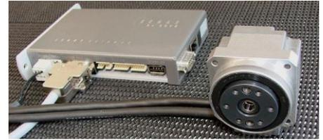
Servomoteur triphasé, à 10 pôles, à transmission sans jeu possède une réduction 1:30
