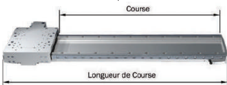
Faible encombrement LINAX® Lxs et Lxu: L montage = course +130 mm
