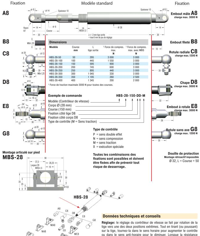
ou dans le sens anti-horaire pour le diminuer. Lorsque la résistance augmente de façon notable, arrêtez de tourner la tige pour éviter tout dommage. Le réglage peut augmenter la longueur L de 6 mm max. (voir les instructions de réglage à la page 60).
