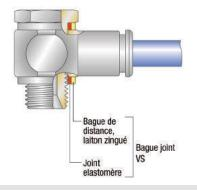
Comme il arrive souvent que les bagues d'étanchéité estampées ne répondent pas aux exigences de l'utilisateur, nous avons amélioré ce dispositif en développant la bague de fermeture VS, qui combine une bague intérieure en élastomère souple et une bague extérieure rigide en laiton nickelé. L'étanchéité est assurée par la bague intérieure souple tandis que la bague extérieure rigide absorbe le couple de serrage généré.
