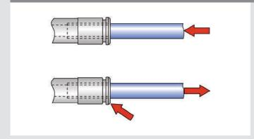
Montage: Engager le tuyau dans le raccord jusqu'à butée
