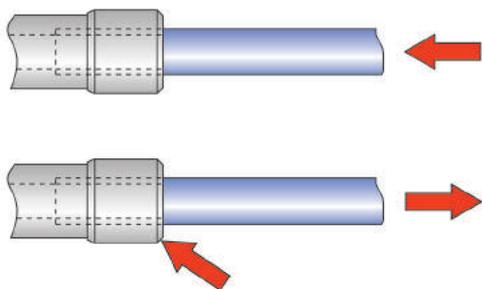
Montage : Engager le tuyau dans le raccord jusqu'à la butée
