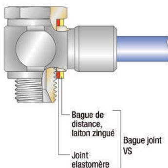
Comme il arrive souvent que les bagues d'étanchéité estampées ne répondent pas aux exigences de l'utilisateur, nous avons amélioré ce dispositif en développant la bague de fermeture VS, qui combine une bague intérieure en élastomère souple et une bague extérieure rigide en laiton nickelé. L'étanchéité est assurée par la bague intérieure souple tandis que la bague extérieure rigide absorbe le couple de serrage.
