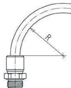
Ne pas imposer de contraintes de traction aux tuyaux à air comprimé une fois ceux-ci montés.
