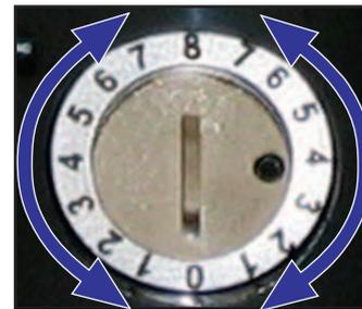
Réglage du vernier sur 360° avec verrouillage en position.
