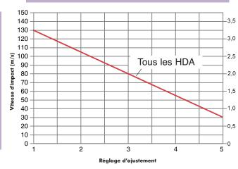
Après avoir sélectionné le modèle HDA, il est possible de déterminer la plage de réglage :
